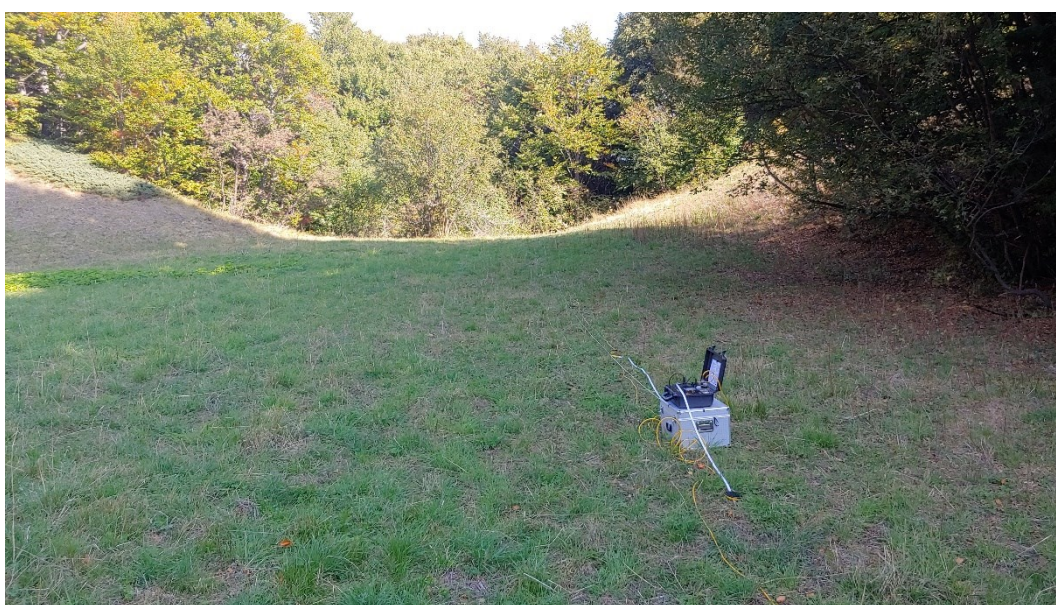
Figura 4 - Sismografo EEG BR24 su stendimento SR01
