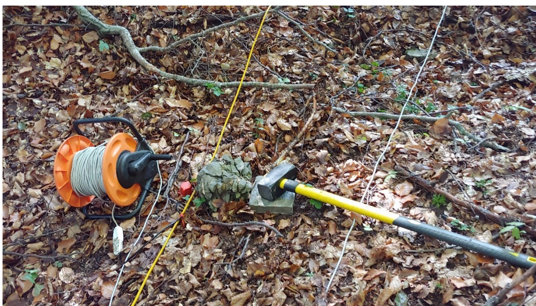
Figura 5 - Strumentazione per l'energizzazione dei punti di battuta.
